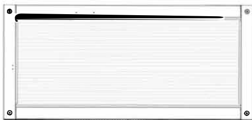
WA07 ASSEMBLAGE DE FENÊTRE - W2A04206 (x2) 1 7/8"x21 13/16"x47 3/16" (48x554x1198)
