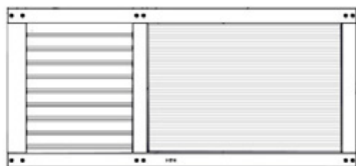
DA01 ASSEMBLAGE DE PORTE - W2A04009 (x1) 1 7/8"x36 9/16"x80" (48x928x2032)
