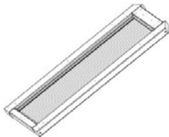
WA09 ASSEMBLAGE DE FENÊTRE - W2A04378 (x1) 1 7/16"x15 1/4"x35 1/4" (36x388x802)
