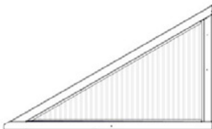
WA02 ASSEMBLAGE DE FENÊTRE- W2A04376 (x1) 1 7/16"x21 3/16"x35 1/8" (36x537x795)
