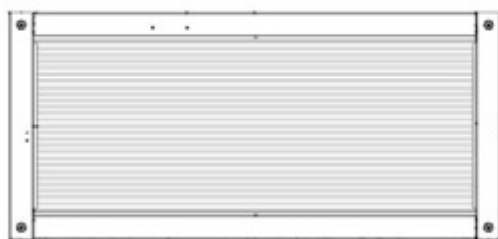
WA07 ASSEMBLAGE DE FENÊTRE - W2A04208 (x1) 1 7/8"x21 13/16"x47 3/16" (48x554x1094)
